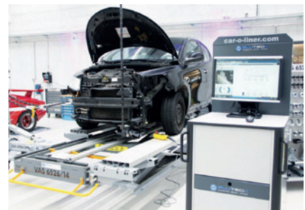
Eine 3D-Fahrzeugvermessungsanlage ist heute in der Unfallinstandstellung ein Muss.
